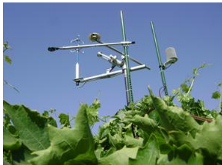
Figura 13: Equipo de medición de flujos de vapor de agua y CO 2
