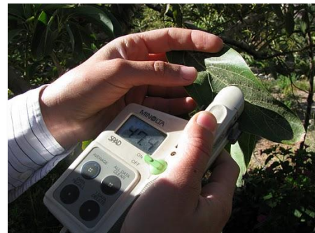
Figura 14: Medición de clorofila en hojas de palto a través de SPAD
