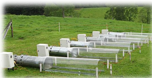
Figura 3: Microtúneles para evaluar pérdidas de amoníaco en praderas del sur de Chile
