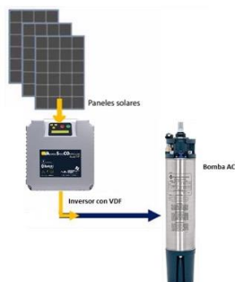
Imagen referencial sistema de bombeo solar sumergible o superficie con Inversor VDF.
