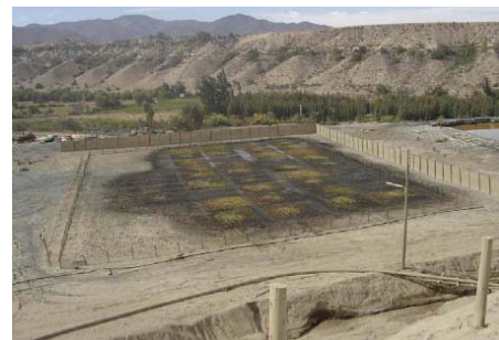
Ensayo Piloto instalado en un tranque de relaves.
