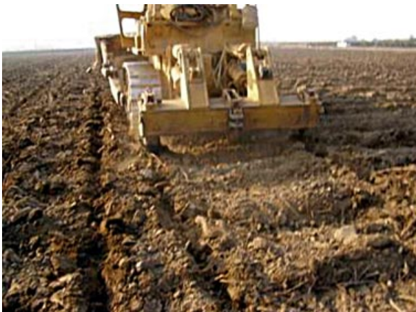
Foto 6. Buldózer D8, con orugas que facilitan la tracción y aumento de la capacidad efectiva de trabajo en la labor de subsolado.
