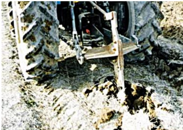
Foto 7. Labor de subsolado con un contenido de humedad de suelo inadecuado.
