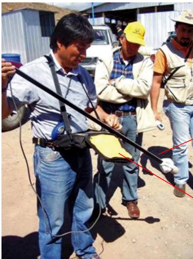
Foto 1. Equipo almacenador de datos (Diviner), que incluye sonda o espada con sensor de capacitancia.
