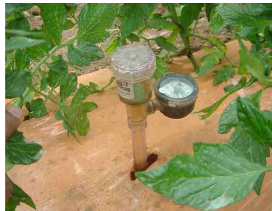
Foto3. Tensiómetro, Instrumento, para verificar la humedad De agua en el suelo.
