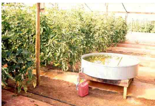
Foto1. Bandeja de evaporación, permite cuantificar la evaporación de agua.
