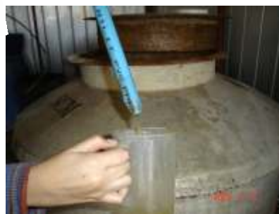
Foto N° 3. Procedimiento de toma de muestra. Extremo distal aguzado.
