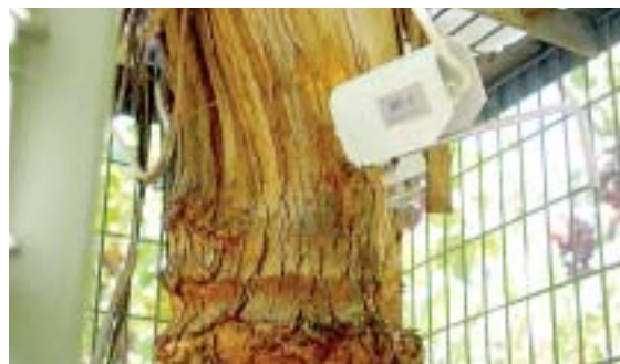
Dendrómetro instalado en tronco de vid para medir variación de diámetro.
