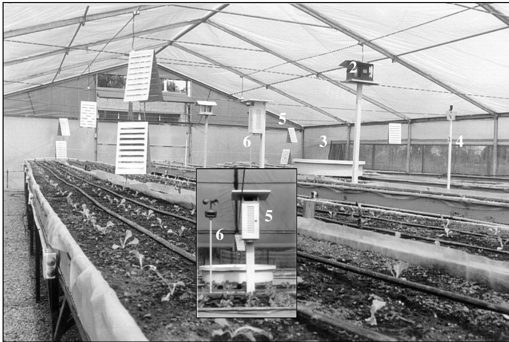
Figura 2. Distribución espacial de dispositivos e instrumentos al interior del invernadero. 1: Atmómetros; 2: Termohigrógrafo; 3: Bandeja clase A; 4: Evaporímetro Andersson; 5: Estación meteorológica; 6: Anemómetro.
